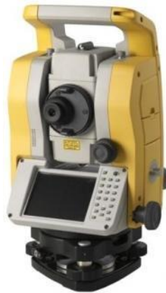
Obrázok 5: Totálna stanica Trimble M3
