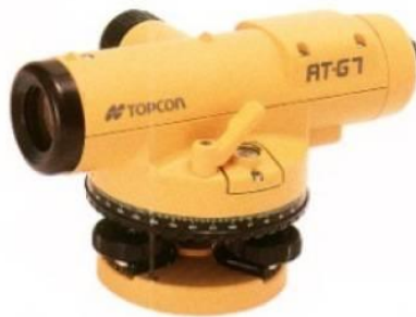
Obrázok 6: Niveláčny prístroj AT-G7
