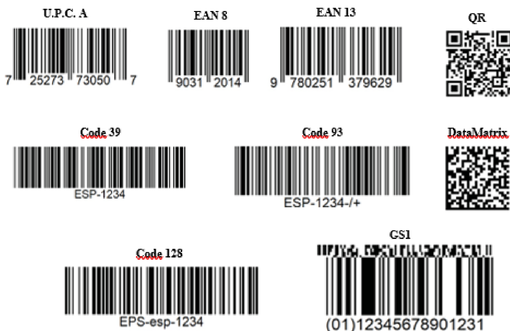
Obr. 1.2 Možné podoby 1D a 2D identifikátorů
