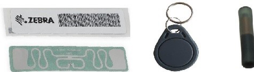
Obr. 1.4 Možné podoby RFID tagů
