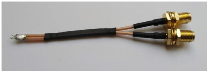
Obrázok 4.3 Koaxiálny prípravok pre dvojportové meranie (prevzaté z [22])
