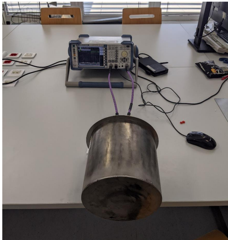
Obrázok 4.5 Wheeler Cap metóda s anténou v uzavretom prostredí
