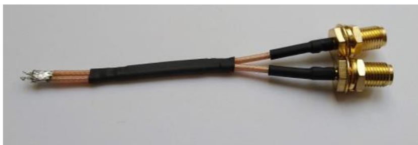
Obrázok 4.3 Koaxiálny prípravok pre dvojportové meranie (prevzaté z [22])
