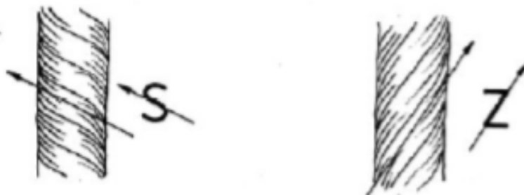
Obr. 11: Směr zákrutu, S - levý zákrut, Z – pravý zákrut [5]
