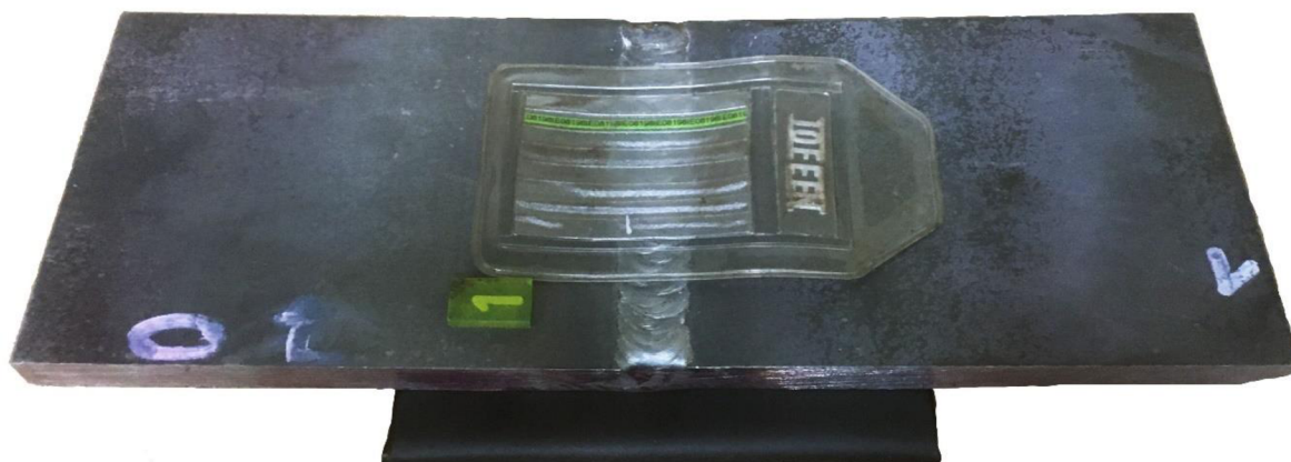
Obr. 28 Označení vzorku 1 před zahájením prozařování
