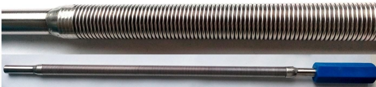
Obr. 38: Tyče pro nanášení elektrodových hmot
