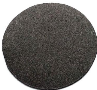
Obr. 39: Vyrobená elektroda z přírodního grafitu 280 H nelisovaná
