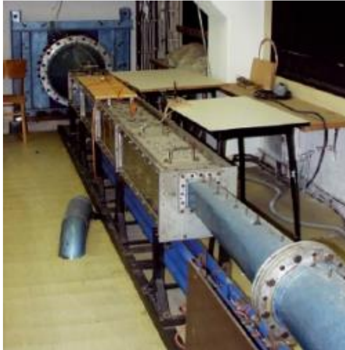
Obrázek č. 16 Vysokorychlostní podzvukový aerodynamický tunel pro výzkum turbulence a mezních vrstev. (CAS [2015-03-02])
