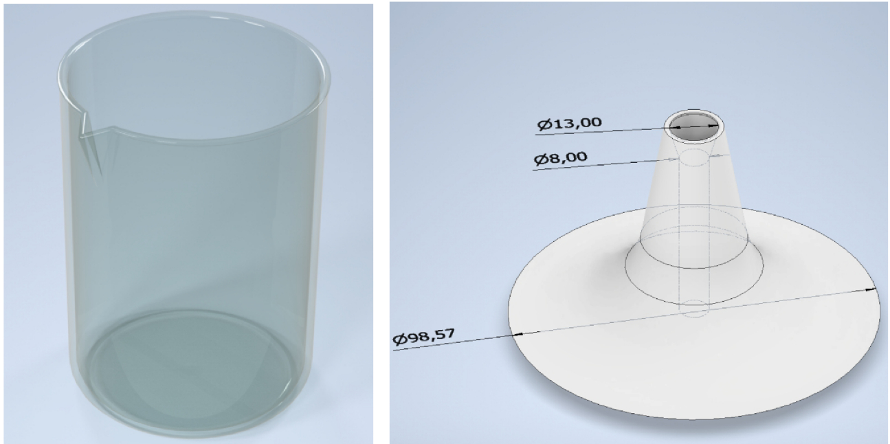
Obr. 20: Kádinka a stojan na miešadlo v programe Inventor
