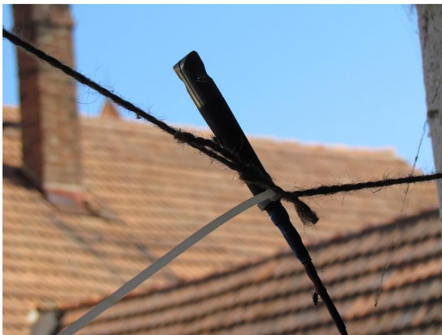
Obrázek č. 15 - Upevnění sondy anemometru
