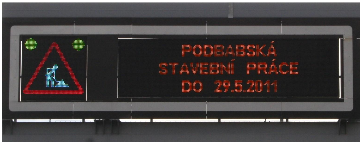
Obrázek 16 Ukázka využití Dot Matrix displeje (foto - autor)
