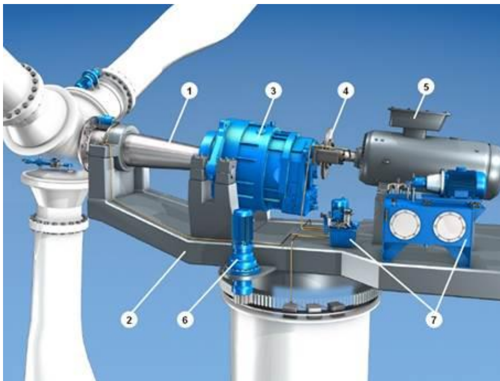
Obrázek 2: Schéma větrné elektrárny s horizontální osou
