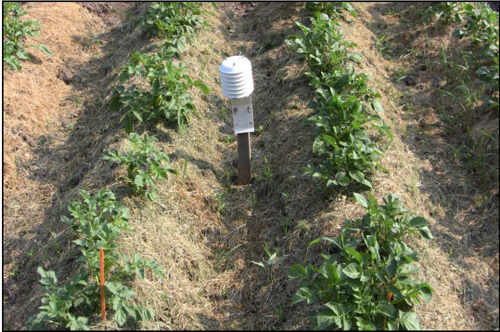
Obrázek 2: Záběr na pokusnou parcelu s rostlinným mulčem a dataloggerem pro měření teploty a vlhkosti vzduchu
