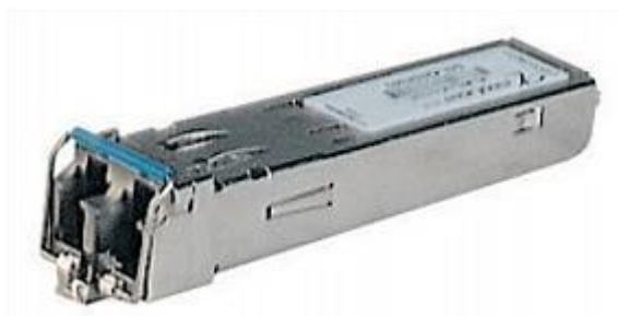
Obrázek 29: SFP modul M-SFP-MX/LC EEC [36]
