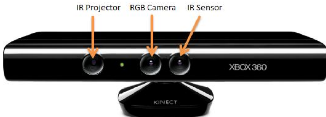
Obrázek 3.6: Kinect a jeho hlavné časti [29].
