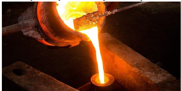
Obr. 5 Odlévání roztaveného kovu [11]
