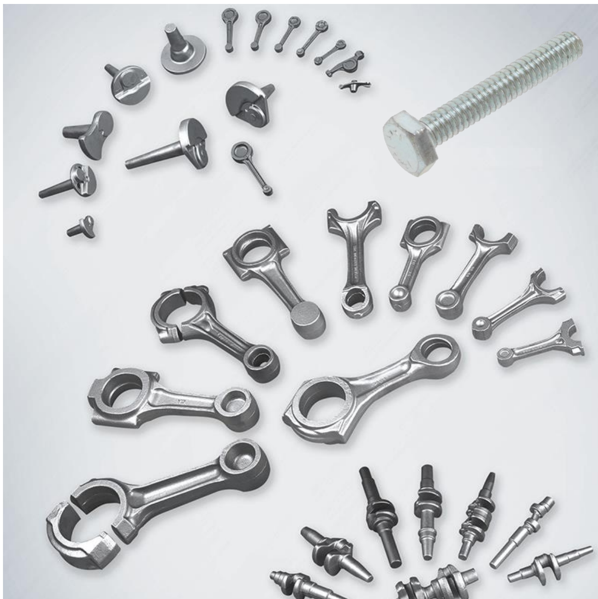
Obr. 1 Ukázka možných součástí zhotovených objemovým tvářením [3], [15]
