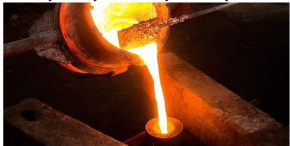
Obr. 5 Odlévání roztaveného kovu [11]
