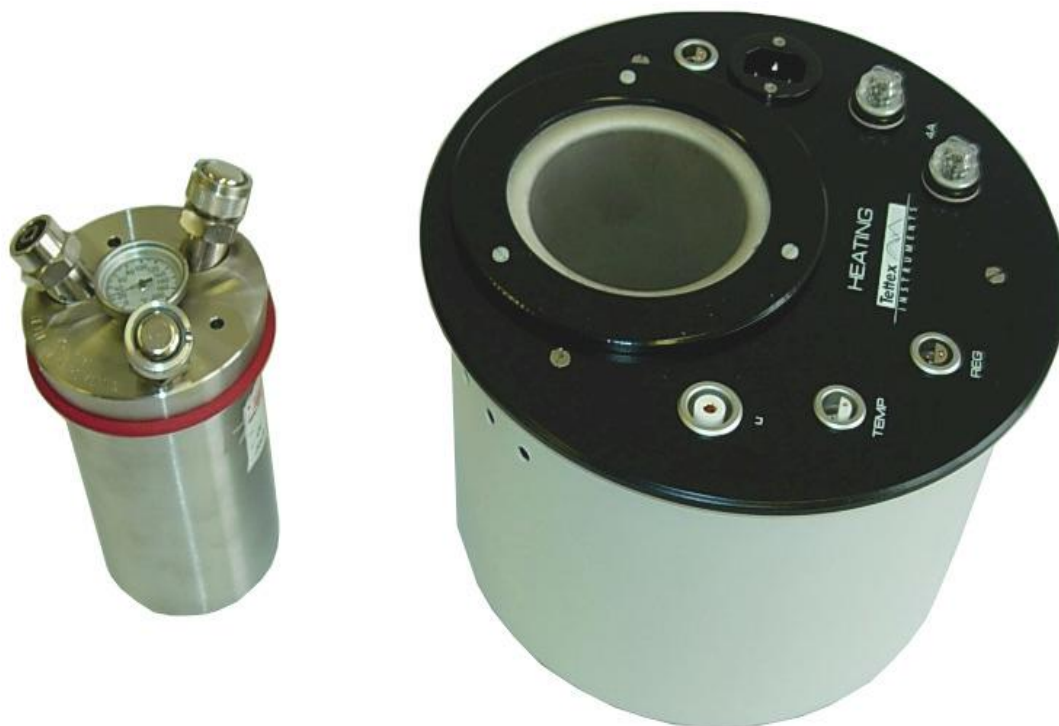
Obr. 10. Měřicí systém 2903 s válcovým kondenzátorem [16]
