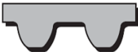
Obrázek 9 – Parabolický tvar ozubení se strženým vrcholem (13)
