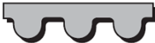
Obrázek 8 – Půlkulatý tvar ozubení (13)
