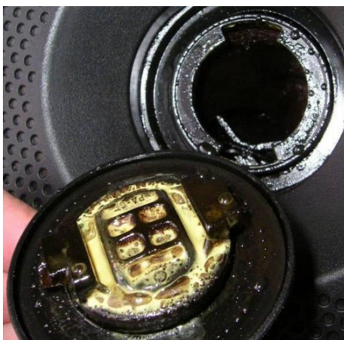
Obrázek 3: Usazená emulze vzniklá nemrznoucí kapalinou v oleji
