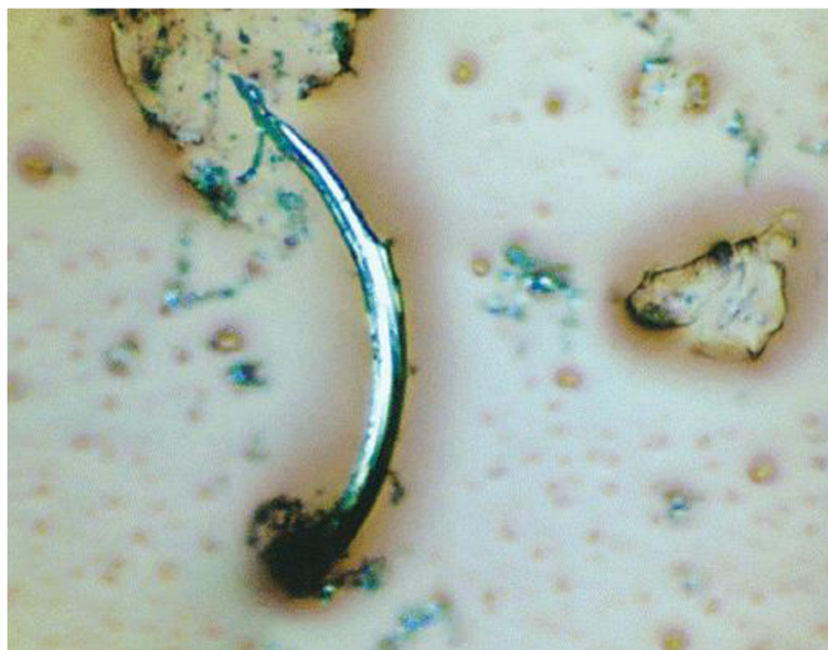
Obrázek 5: Otěrová částice vzniklá při zadírání motoru
