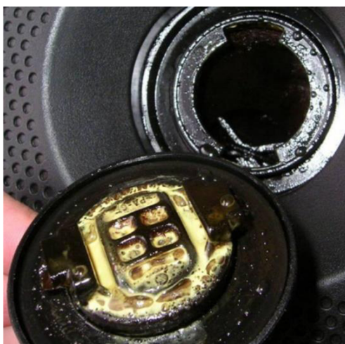
Obrázek 3: Usazená emulze vzniklá nemrznoucí kapalinou v oleji
