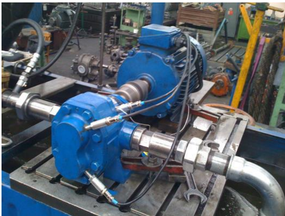
Obr. 40 Čerpadlo osazené snímači pro monitorování třecího tepla
