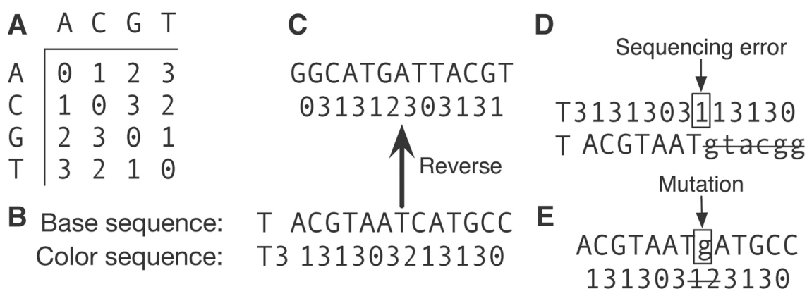
Obrázek 4.6: Zarovnání sekvenčních čtení přístroje SOLiD [32].
