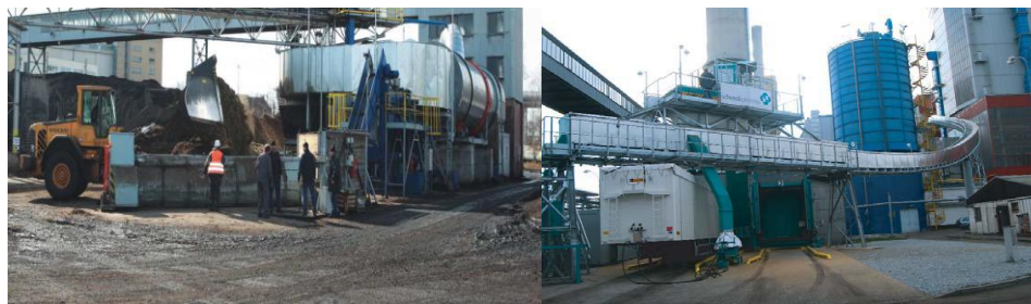
Obr. č. 16 Sklad biomasy a pásový dopravník pro transport biomasy do kotle K7
