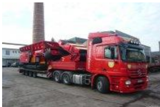
Obr. č. 13 Drtič na pásovém podvozku Hammel Red Giant (Holomac)
