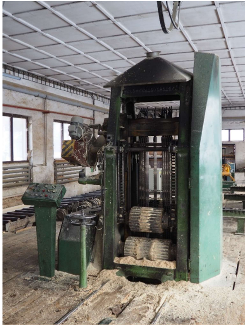
Obr. 21 Rámová pila podniku
