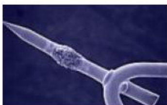
Obr. 3-6: Schottkyho zdroj elektronů [20]
