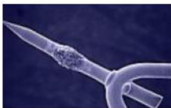
Obr. 3-6: Schottkyho zdroj elektronů [20]
