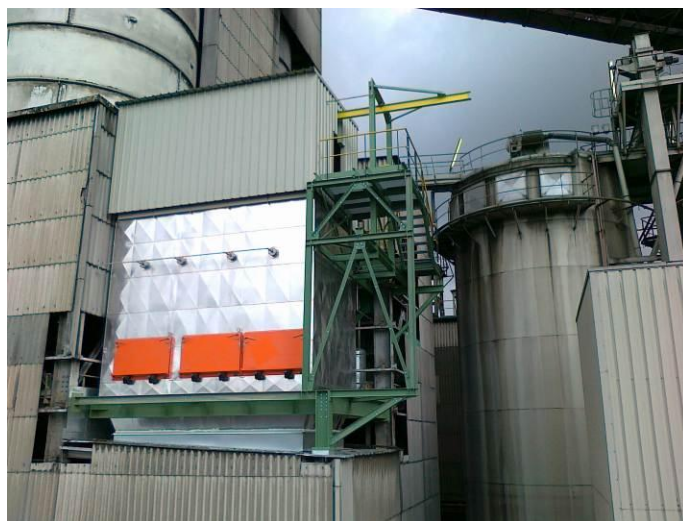
Obr. 6.3 Usazený filtr a obslužné plošiny
