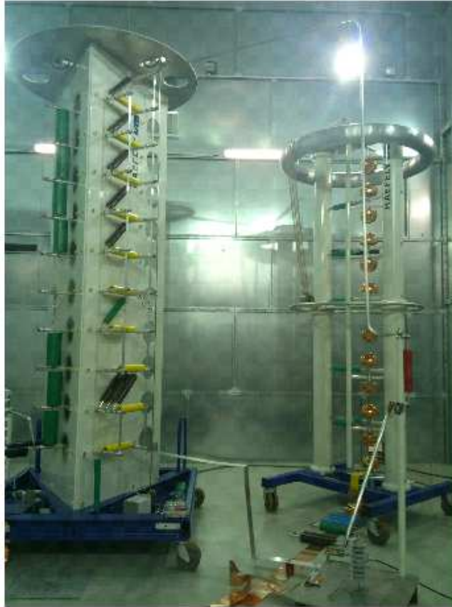
Obr. 6-3: Zapojení Marxova generátoru pro měření omezovače přepětí při standardizovaném proudovém impulzu 8/20 \mu s
