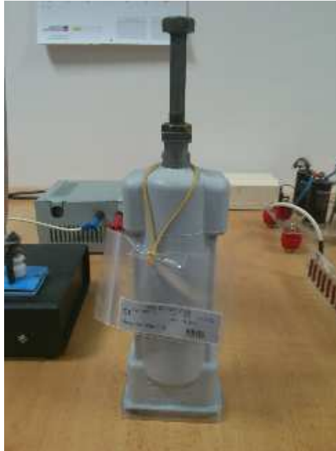
Obr. 6-4: Omezovač přepětí typu MWD U_C = 10 kV
