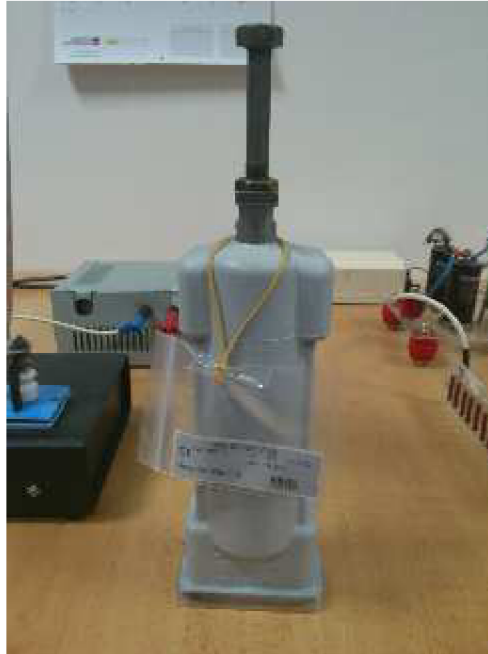
Obr. 6-4: Omezovač přepětí typu MWD U_C = 10 kV
