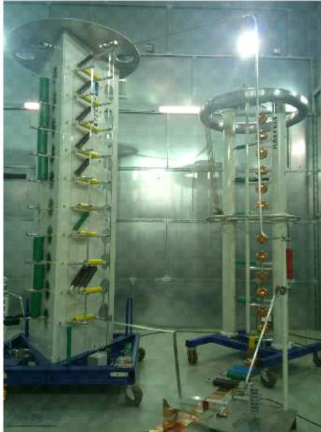
Obr. 6-3: Zapojení Marxova generátoru pro měření omezovače přepětí při standardizovaném proudovém impulzu 8/20 \mu\text{s}
