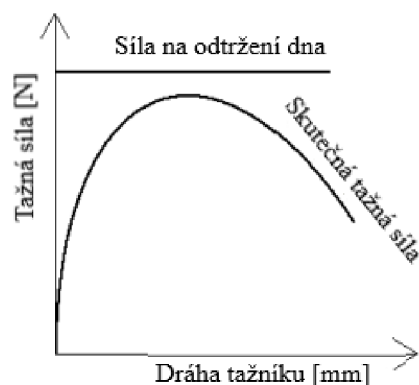
Obr. 16 Průběh tažné síly [3].
