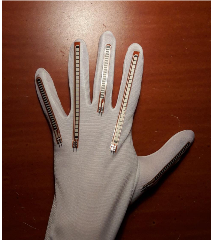
Obrázek 9: Umístění flex senzorů na jednotlivé prsty
