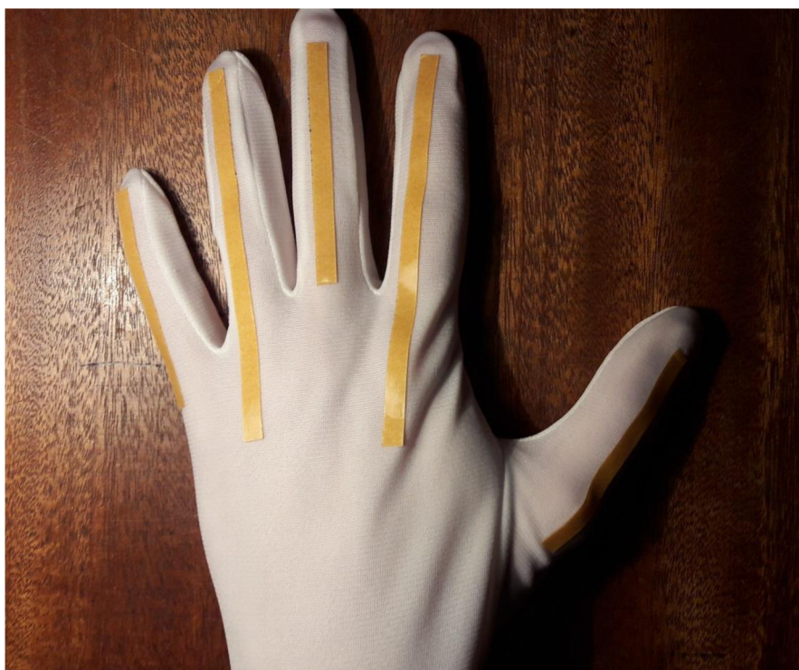
Obrázek 8: Rukavice s proužky textilní oboustranné lepicí pásky
