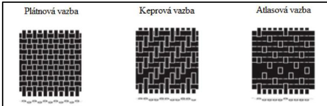
Obrázek 1 – Typy textilních vazeb [1]
