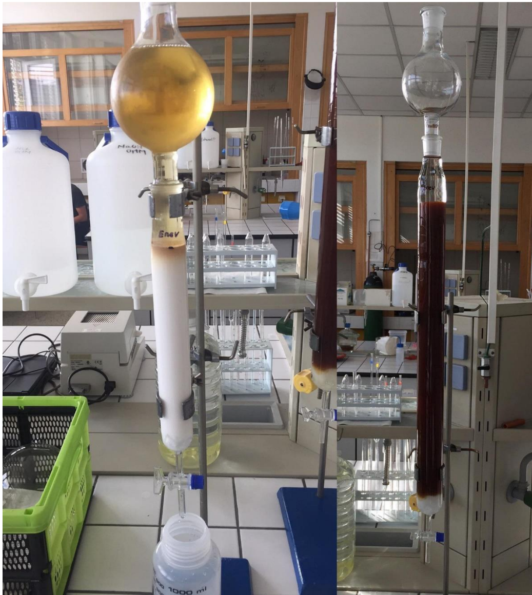
Obrázok 12: Kolona naplnená živicom DAX-8, použitá v kapitole 3.4.1 Adsorpcia fulvínových kyselín na živicu ; kolona naplnená katexom Amberlite IR 120 použitá v kapitole 3.4.2 Protonácia fulvínových kyselín na živici
