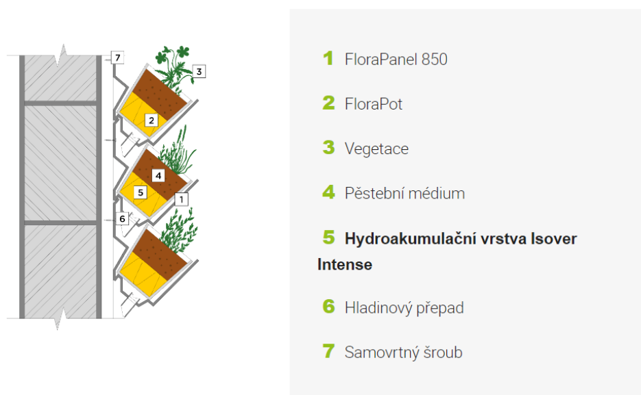
Obr. 35 - Skladba zelené stěny firmy Isover [67]
