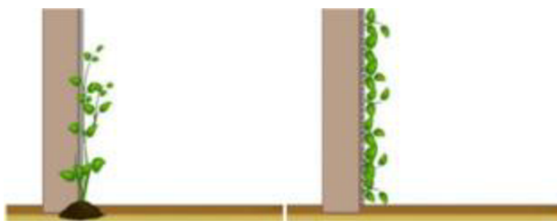
Obr. 25 - Zelená fasáda (vlevo) a živá stěna (vpravo) [43]
