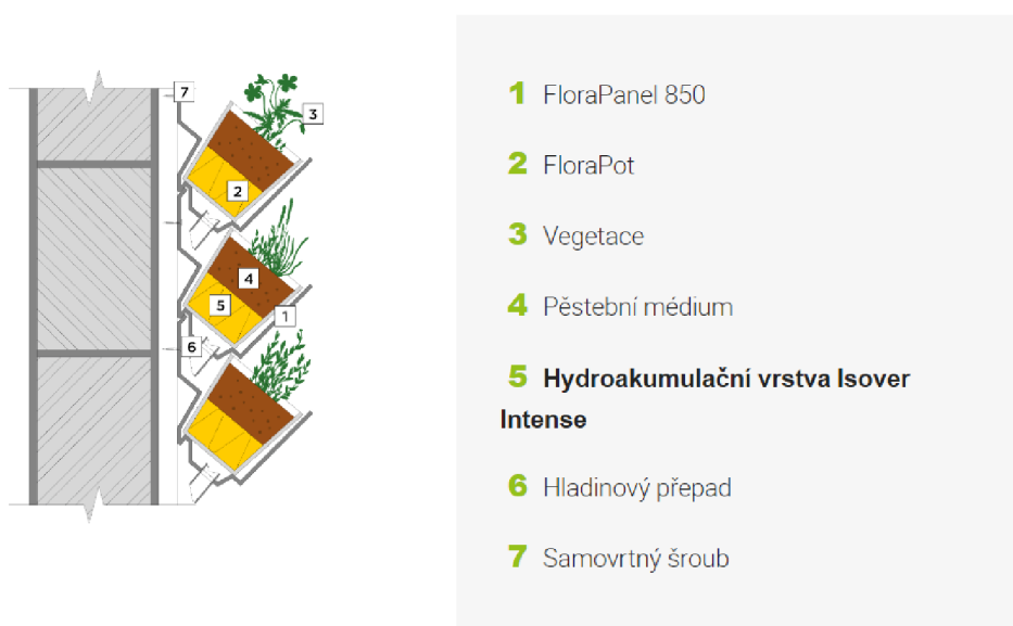
Obr. 35 - Skladba zelené stěny firmy Isover [67]
