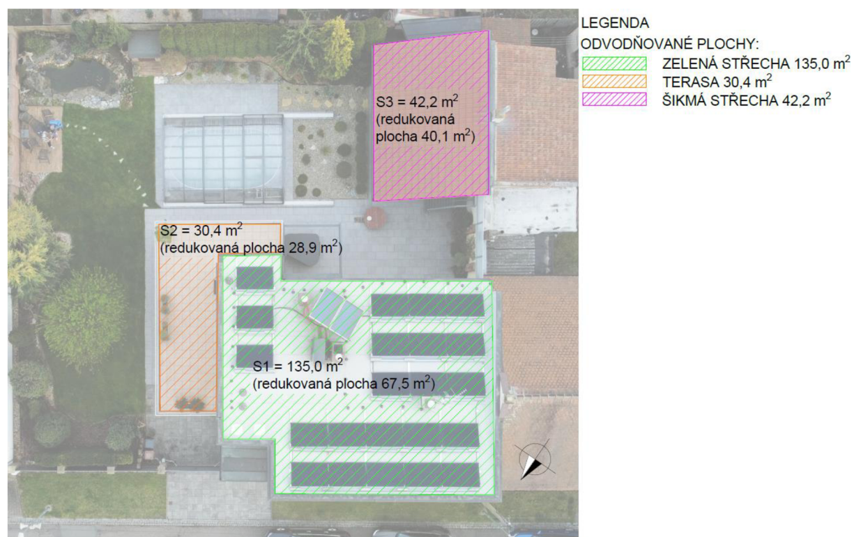
Obr. 36 - Odvodňované plochy (vlastní zdroj)
