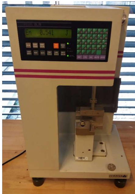
Obr. 43 Zkušební zařízení Resil 5.5
