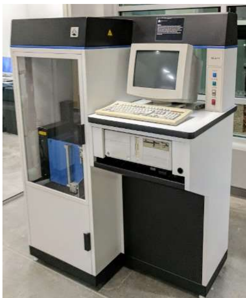
Obr. 3 První 3D tiskárna SLA-1 [6]
