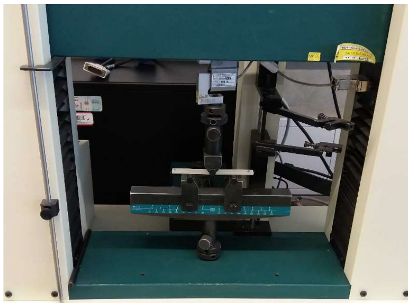
Obr. 40 Zkušební zařízení Hounsfield H10KT
