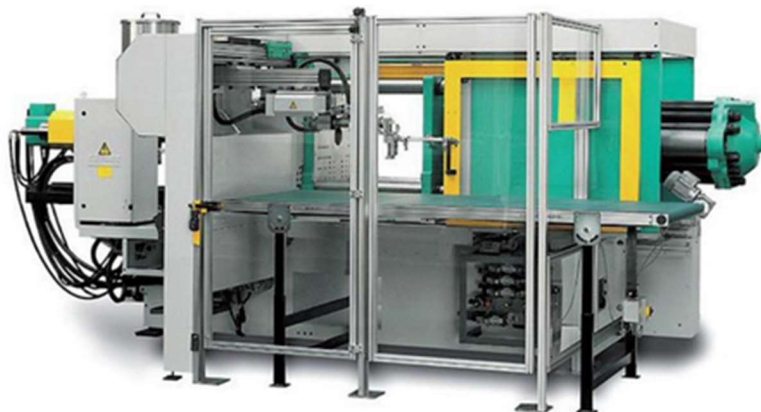
Obr. 23 Vstříkovací stroj ARBURG 270S 400-100 [38]
