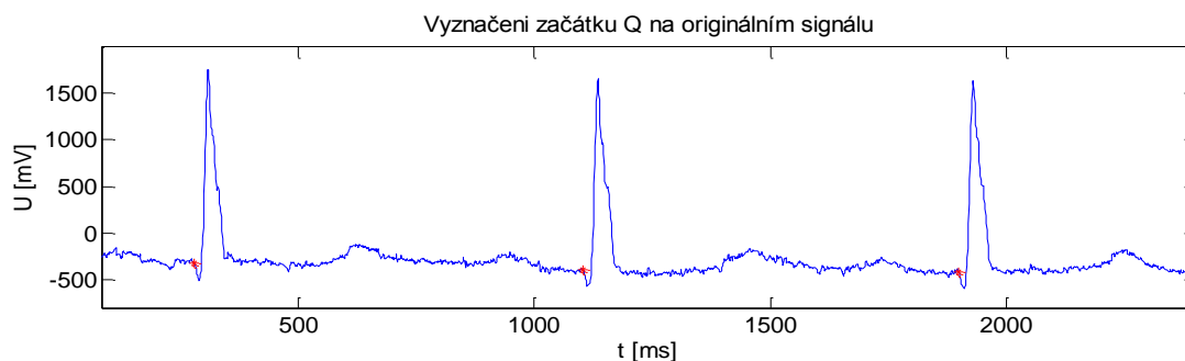
Obr. 31 Zobrazení detekce kmitu Q na originálním signálu.
