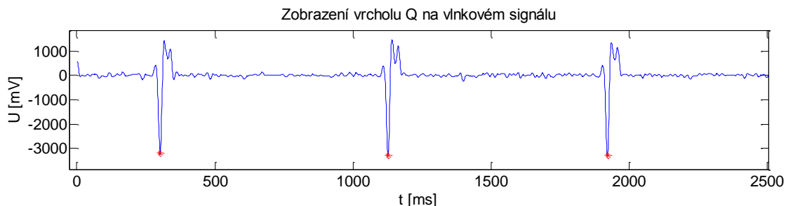
Obr. 30 Zobrazení detekce kmitu Q na signálu zpracovaném vlnkovou transformací.
