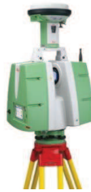
Obr. 3: Laserový skener Leica doplnený GNSS prijímačom ( http://www.geotech.sk/img/Laserove-skenery-HDS/P20/P_0563_POWERPOINT_resize.jpg )
