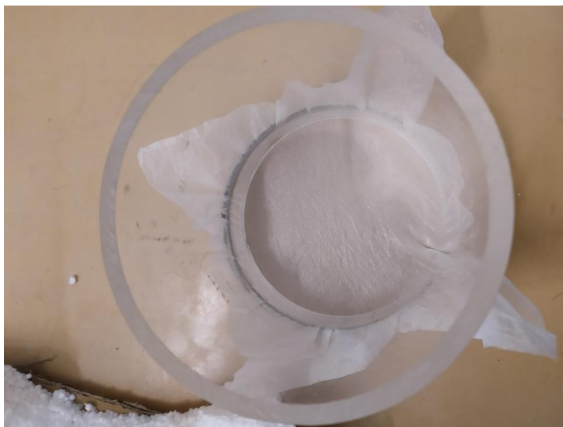
Obr. 23: Filtrační síto na veligery, uchyceno gumou; foto K. Stržínková 2020
