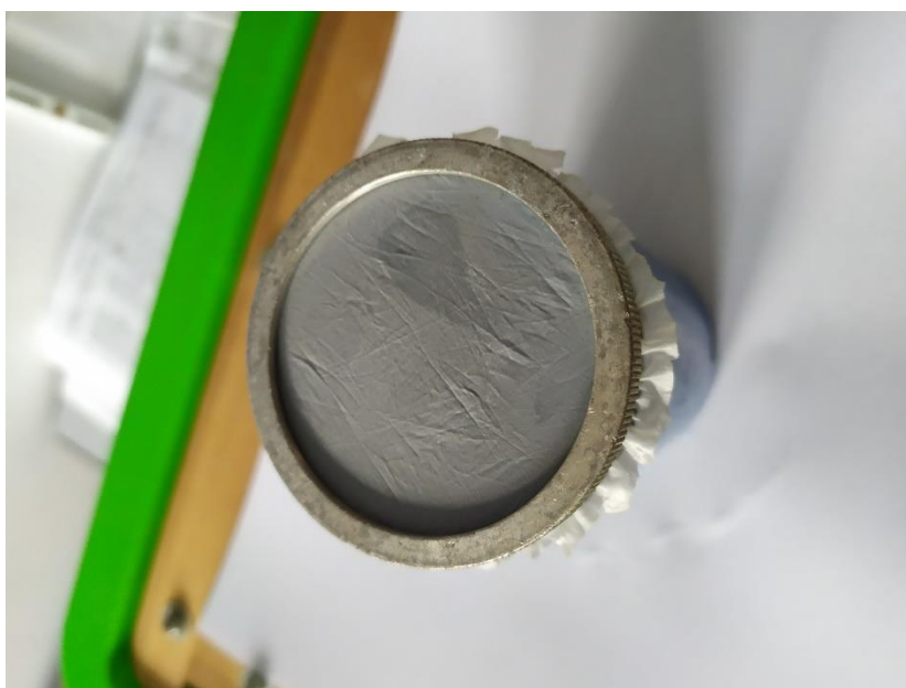
Obr. 24: Filtrační síto na veligery; majitel RNDr. Vladimír Uvíra, Dr; uchyceno kovovým kroužkem; foto K. Stržínková 2020
