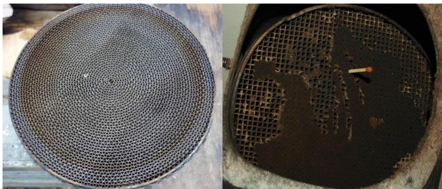
Obrázek 26 – Platinový katalyzátor s kovovou mříží (vlevo) a ucpaný katalyzátor [40]
