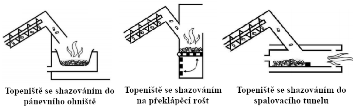
Obrázek 4 - Konstrukce topenišť s horním přívodem paliva [15]
