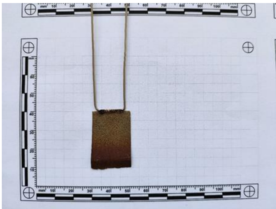
Obrázek 8.2 Ocelový drát přivařený ke zkušebnímu vzorku
