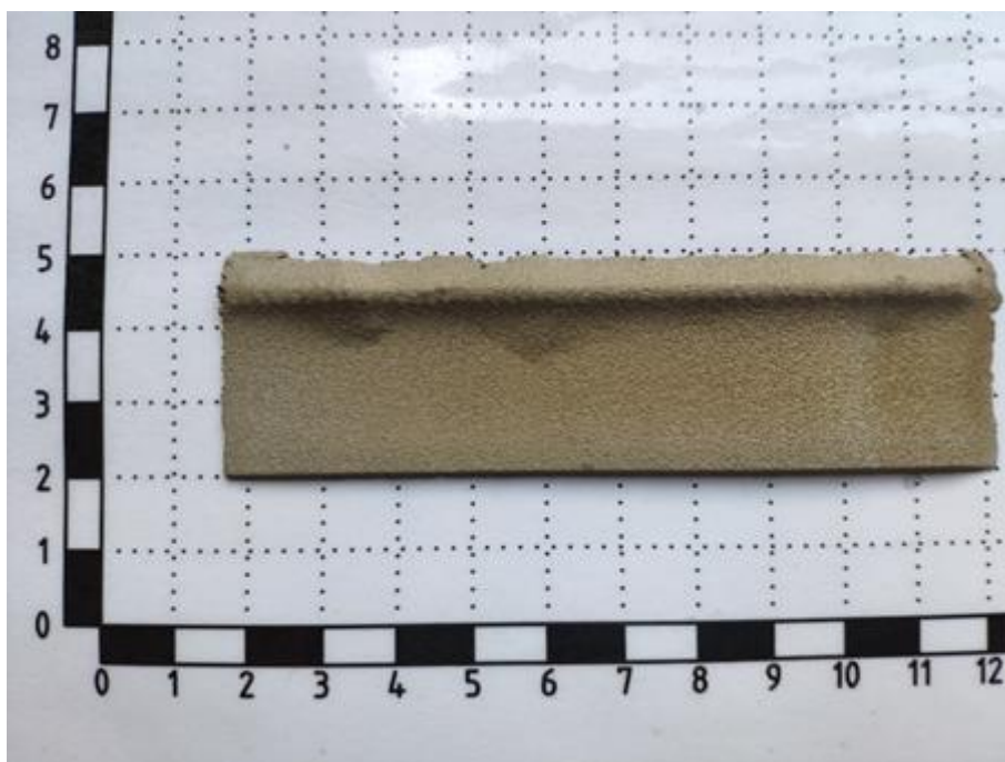
Obrázek 8.1 Destička z oceli 304L nanesená metodou CS
