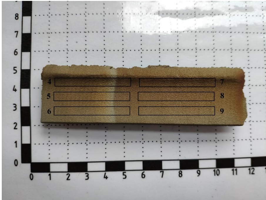
Obrázek 8.19 Odběr vzorků z oceli 304L
