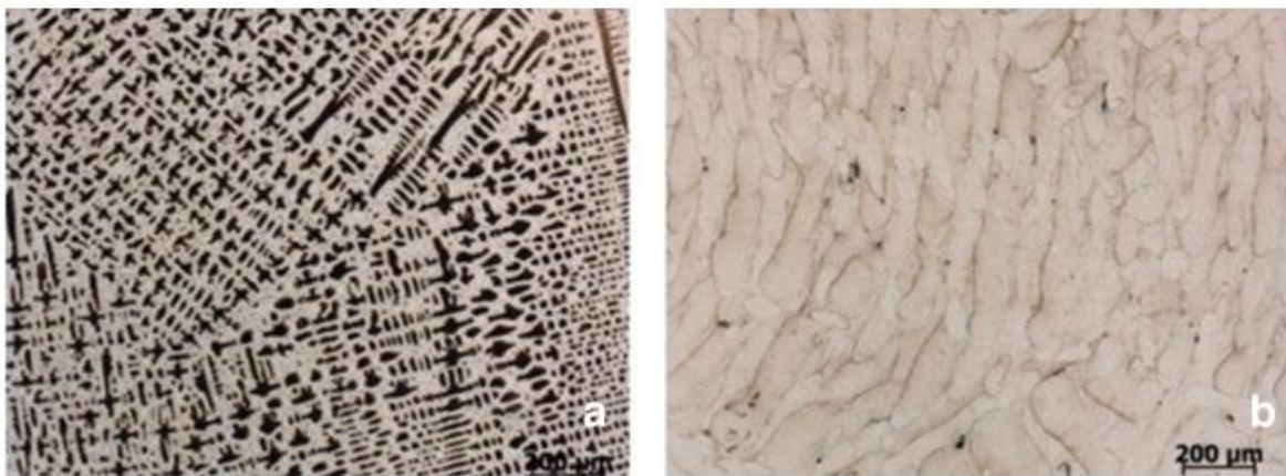
Obrázek 7.4 Mikrostruktura slitiny Co-Cr-Mo v litém stavu a) a vytvořená metodou SLM b) [14]
