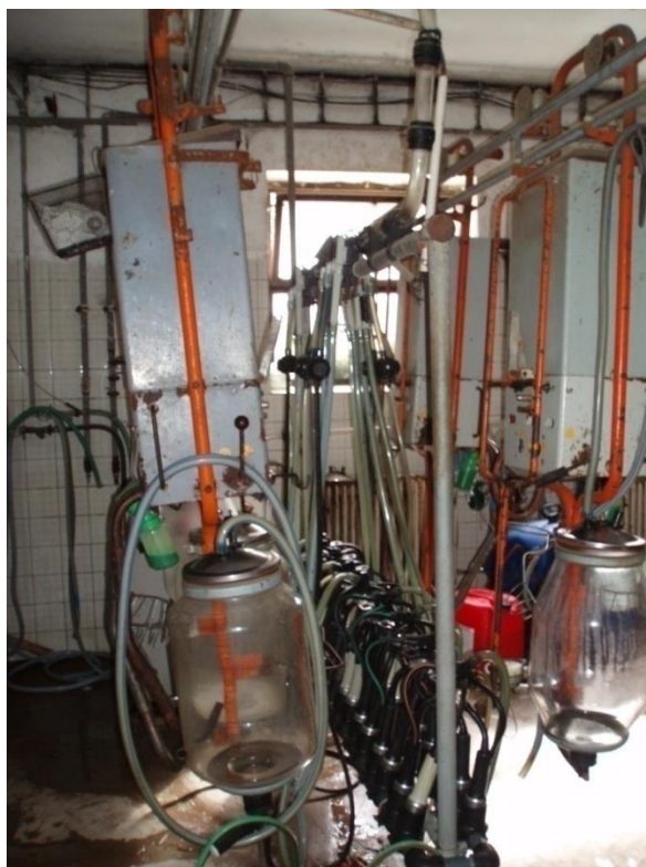
Obr. č. 13: Pojízdné dojící zařízení (KLAP, 2012)
