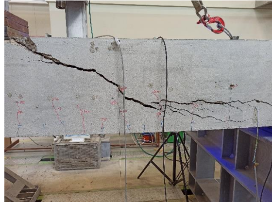
obr. 7.11: detail porušení nosníku – vzorek A [ 19 ]
