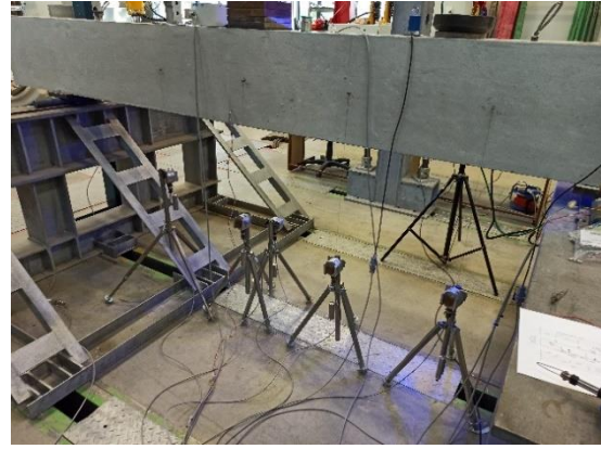
obr. 7.7: osazení snímačů – vzorek B [ 19 ]
