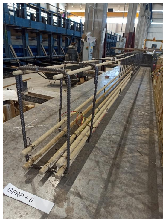
obr. 7.2: armokoš – vzorek B [ 19 ]
