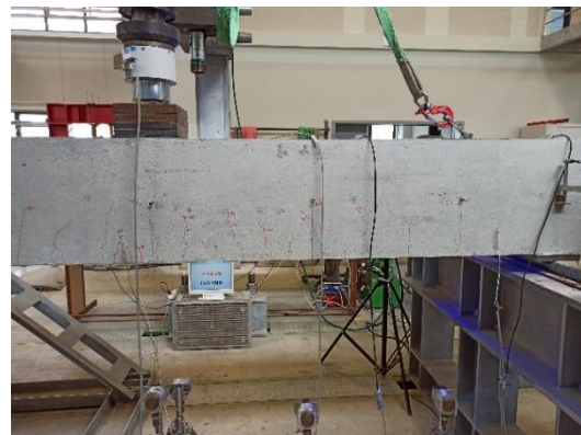
obr. 7.9: rozvoj trhlin – vzorek A [ 19 ]
