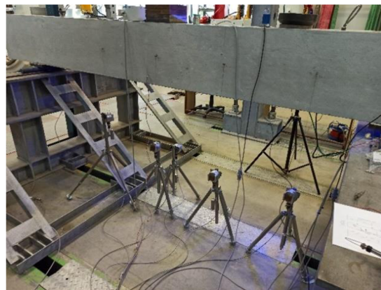
obr. 7.7: osazení snímačů – vzorek B [ 19 ]
