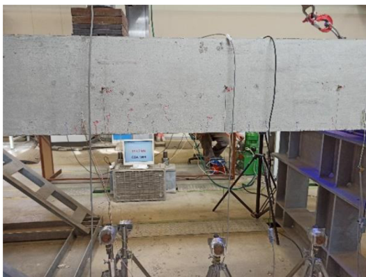
obr. 7.8: vznik a rozvoj trhlin – vzorek A [ 19 ]
