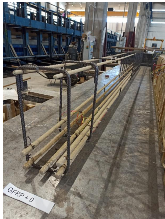
obr. 7.2: armokoš – vzorek B [ 19 ]
