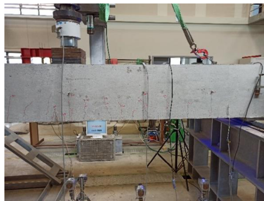
obr. 7.9: rozvoj trhlin – vzorek A [ 19 ]
