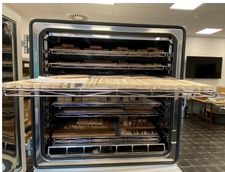
Obrázek 13 – Vzorky v klimatizační komoře (autor)
