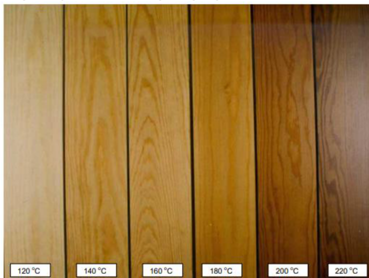
Obrázek 12- Změna barvy dřeva vlivem teploty úpravy (ITA, 2003)
