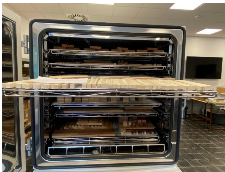
Obrázek 13 – Vzorky v klimatizační komoře (autor)
