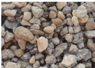
Obr. č. 11 – Nadsítní frakce (betonová)
