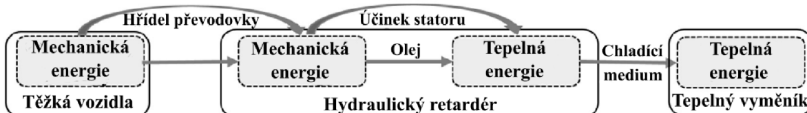
Obr. 14 Změna energie v hydrodynamickém retardéru (upraveno z [14])
